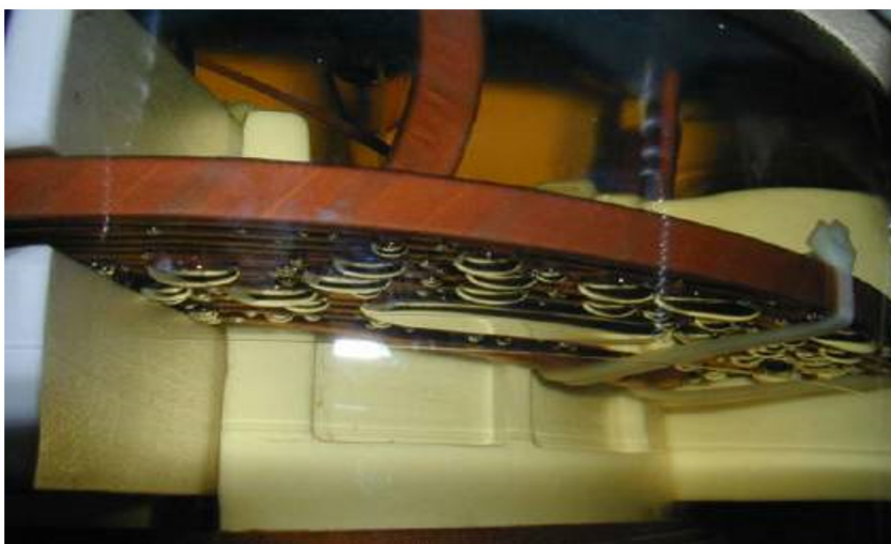
Obr.7 Bubliny zachycené v diskovém vinutí transformátoru
